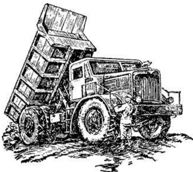
Самосвал МАЗ-525 грузоподъемностью 25 тонн
