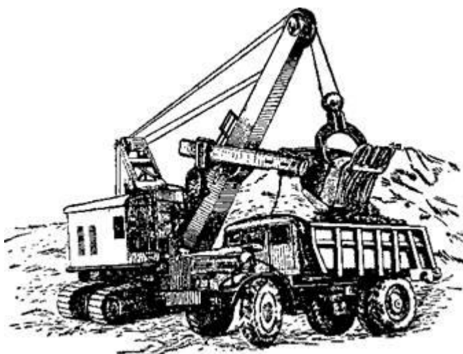
Экскаватор СЭ-3 с электроприводом и объемом ковша 3 м 3
