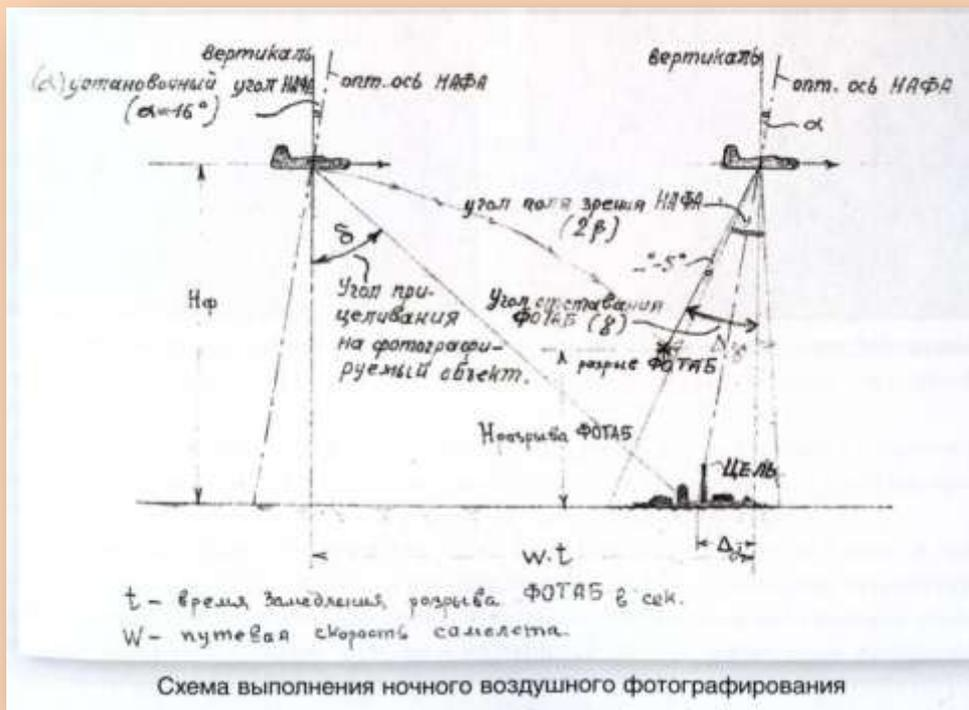
Для получения хорошего ночного аэроснимка необходимо добиться оптимального взаимного расположения объекта разведки, точки взрыва фотобомбы и поля зрения аппарата. Это достигается путем расчета угла отклонения оптической оси фотоаппарата от вертикали, времени замедления взрыва фотобомбы и угла прицеливания на объект.
